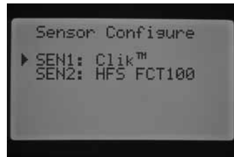
SEN 1: SENSORE CLIK SEN 2: SENSORE DI FLUSSO (HFS FCT100)
