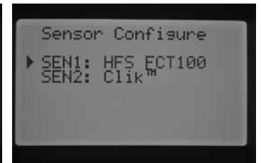
SEN 1: SENSORE DI FLUSSO (HFS FCT100) SEN 2: SENSORE CLIK
