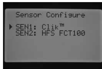
SEN 1 - SENSOR DO TIPO CLIK SEN 2 - SENSOR DE CAUDAL (HFS FCT100)
