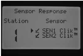
Ambos os sensores programados para a Estação 1
