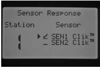
Sadece 1. sensör 1. istasyon için programlanmıştır
