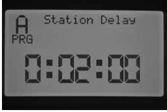
ÖRN.: A PROGRAMI İÇİN İSTASYON GECİKTİMESİ 2 DAKIKADIR
