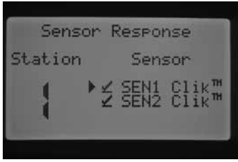
Tüm sensörler 1. istasyon için programlanmıştır
