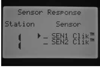
1. istasyon için sensör programlanmamıştır
