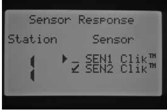
Sadece 2. sensör 1. istasyon için programlanmıştır
