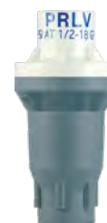
PRLV — Válvula limitadora para regulação de pressão Ampla faixa de vazão Largura: 6,4 cm Comprimento: 14,7 cm Entrada FNPT de ¾" x saída FNPT de ¾"
