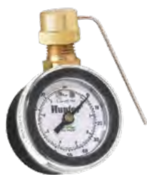
Манометр Пито Арт. № 280100SP Используется для контроля рабочего давления в роторных разбрызгивателях
