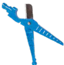
Multifunkčný nástroj na emitory Hunter P/N HEMT (Slúži na dierovanie, vkladanie a odstraňovanie emitorov a strihanie potrubí)
