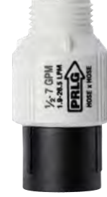
PRLG - Basınç Regülatörü Peyzaj Sınıfı Genişlik: 41 mm Uzunluk: 79 mm ¾" FHT giriş x ¾" MHT çıkış
