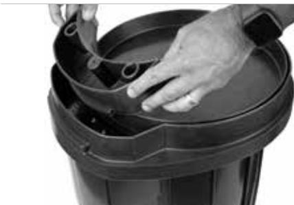
10. Una volta installato l'inserto TTS, fissarlo utilizzando le viti in dotazione. Premere verso il basso i tappi neri per coprire le aperture delle viti.
