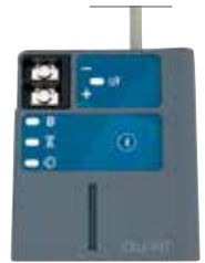
CELLKIT ICC2控制器的蜂窝网络连接附件, 通过Centralus软件管理 见52页
