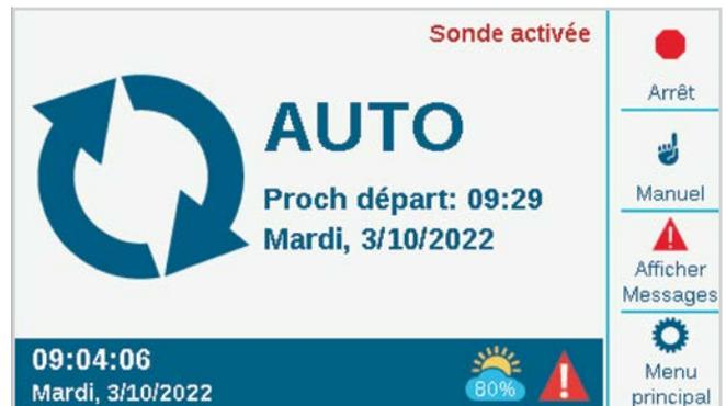
Si une sonde Solar Sync™ est installée et activée (menu **Appareils**), le symbole Solar Sync indique le pourcentage du réglage actuel dans le coin inférieur droit.
