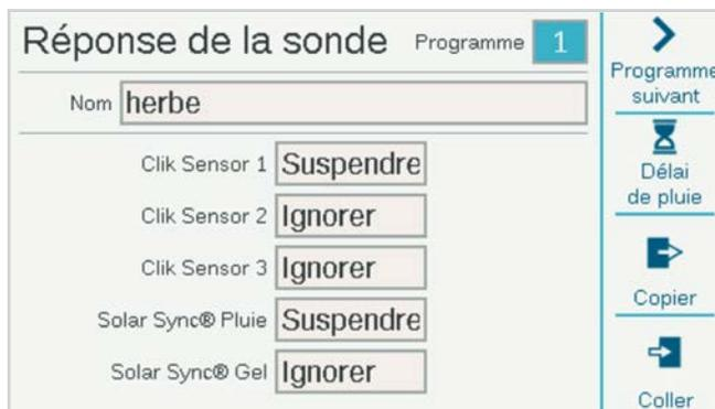
Il y a trois entrées de sonde Clık standard sur le panneau d'alimentation. Si une sonde Solar Sync Hunter a été configurée, il y a également des paramètres pour la pluie et le gel Solar Sync.
