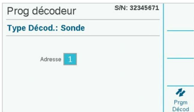
Sélectionnez l'adresse du décodeur de sonde, puis appuyez sur la touche de fonction Programmer le décodeur pour programmer le décodeur. Marquez le décodeur et installez-le au niveau de l'emplacement de la sonde.
