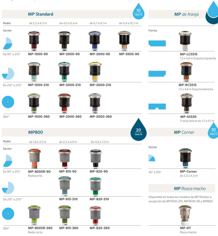
Nota: La MP800 tiene una tasa de precipitación de 20 mm/h. Como esta tasa de precipitación difiere de los 10 mm/h de precipitación del MP Rotator estándar, recomendamos sectorizar la MP800 por separado para que cada zona mantenga una precipitación homogénea. Las franjas MP se pueden utilizar tanto con las MP Rotator estándar como las MP800, dependiendo del diseño.
