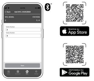
Collegare l'app al modulo di uscita del Wireless Valve nel programmatore. Usare il pulsante app + per assegnare i numeri delle stazioni e salvare. La spia di assegnazione di Wireless Valve Link lampeggerà e poi si spegnerà quando la programmazione sarà riuscita.
