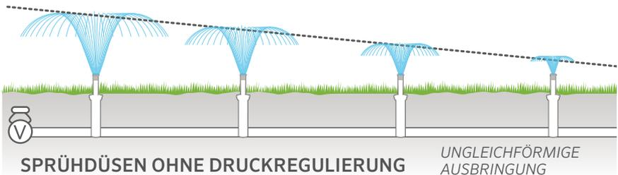
Ohne Druckregulierung liegt an jedem Regner, je nach Lage innerhalb der Anlage, ein unterschiedlicher Druck an. So hat beispielsweise der letzte Regner in einer Reihe einen niedrigeren Gesamtdruck als der erste.
