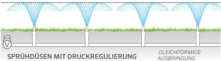
Bei Auslegung mit dem druckregulierenden Pro-Spray PRS40 wird jeder Regner präzise auf 2,8 bar (280 kPa), den optimalen Druck für die MP Rotator Düse, reguliert.
