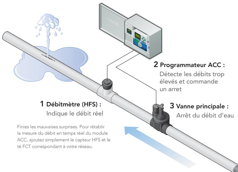
Finies les mauvaises surprises. Pour rétablir la mesure du débit en temps réel du module ACC, ajoutez simplement le capteur HFS et le té FCT correspondant à votre réseau.
