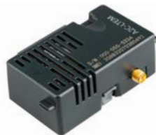
A2C-LTEM Altura: 3" Ancho: 2¼" Profundidad: 1"
