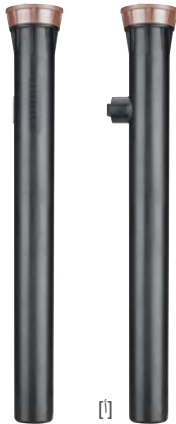
PROS-12-SI-PRS30 [ب] PROS-12-PRS30 [ب] ارتفاع الارتداد: 41 سم ارتفاع القافز: 30 سم القطر الظاهر: 5.7 سم حجم المدخل: ½ بوصة
