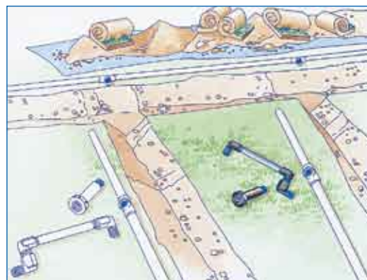
Disposer les tuyaux et les arroseurs le long des tranchées à l'endroit où ils vont être posés.
