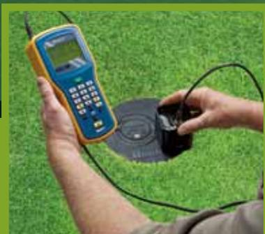
◀ SENCILLA PROGRAMACIÓN DEL DECODIFICADOR DESDE LA SUPERFICIE CON EL ICD-HP. RÁPIDA Y SIN NECESIDAD DE DESMONTAR.
