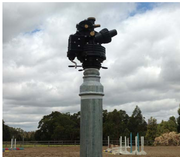
Zainstalowano dyszę ST-1600-HS-BR
