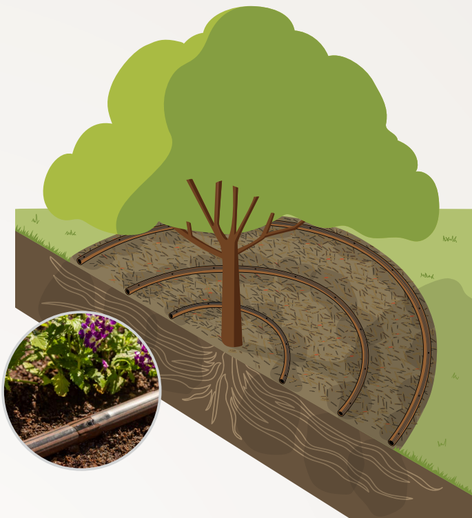
אפשר לשנות בקלות את הסידור של HDL כך שיתאים לטפטוף המשתנה ולצורכי המים של עצים בוגרים.
