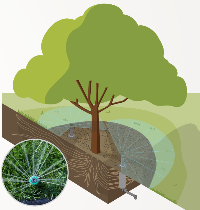
אפשר לשנות RZWS ופיות באבלר לפיות MP Rotator על גופי ריסוס מתקפלים, לפי צורכי פיזור המים של עצים מתבגרים.
