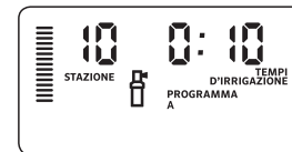
Esecuzione del ciclo della stazione 10
