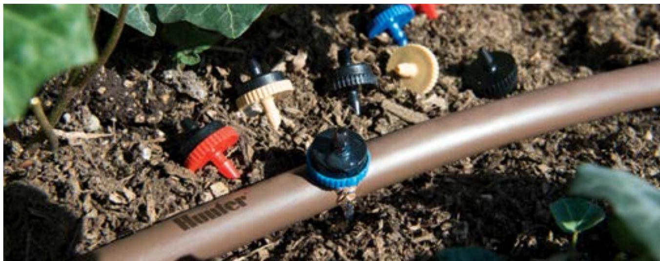
Los emisores con compensación de presión de Hunter proporcionan un riego preciso directamente en la zona de las raíces de la planta. Están disponibles en tres modalidades: dentado de 6 mm, rosca de 10-32, y rosca hembra de 1/2" (FPT). Todos los modelos tienen caudales de 2,0; 4,0; 8,0; 15,0; y 23,0 l/h.
