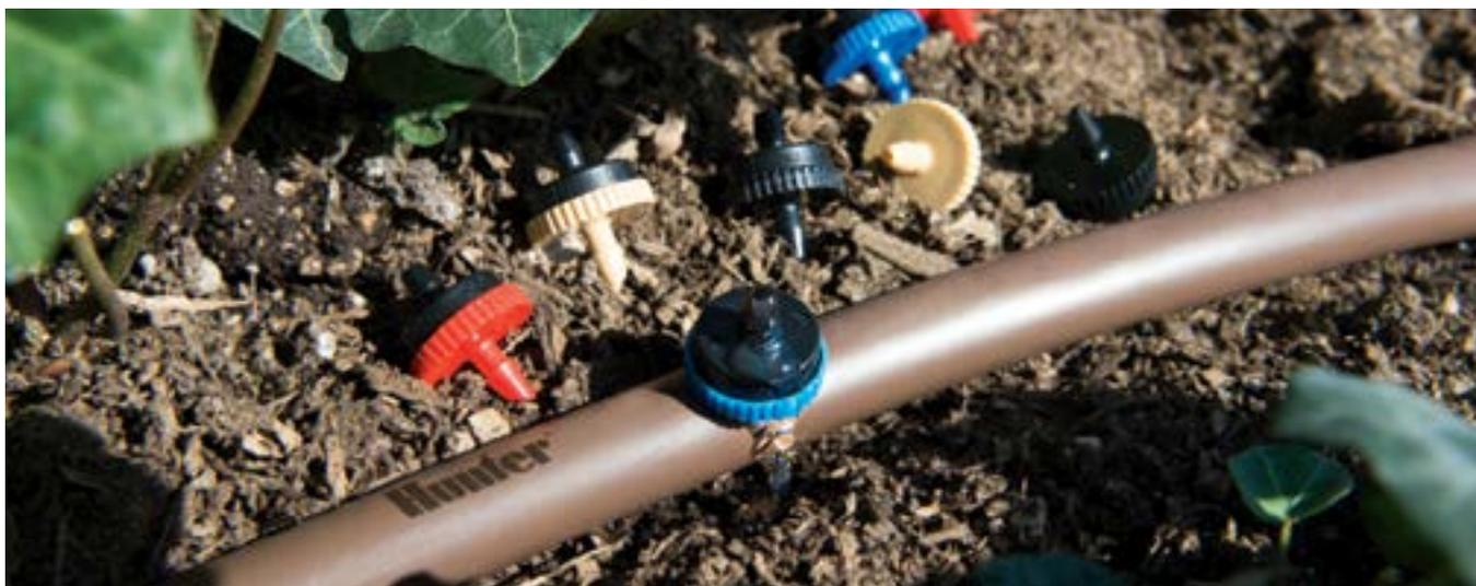
Os gotejadores com compensação de pressão da Hunter possibilitam uma irrigação precisa diretamente na zona da raiz da planta. Eles estão disponíveis em três estilos convenientes: conector auto-perfurante de 6 mm, roscas 10-32 ou rosca fêmea de 1/2" NPT e com vazões de 2,0; 4,0; 8,0; 15,0 e 23,0 l/h.
