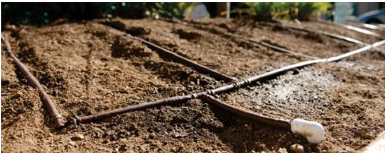
O tubo gotejador profissional de paisagismo (PLD) é uma solução da Hunter para plantações e jardins densos do mundo inteiro. Com emissores com válvulas antidreno integradas, o PLD garante a distribuição consistente da água de forma lenta e uniforme. Ele é usado principalmente em níveis, mas também pode ser usado em subsuperfícies quando necessário.
