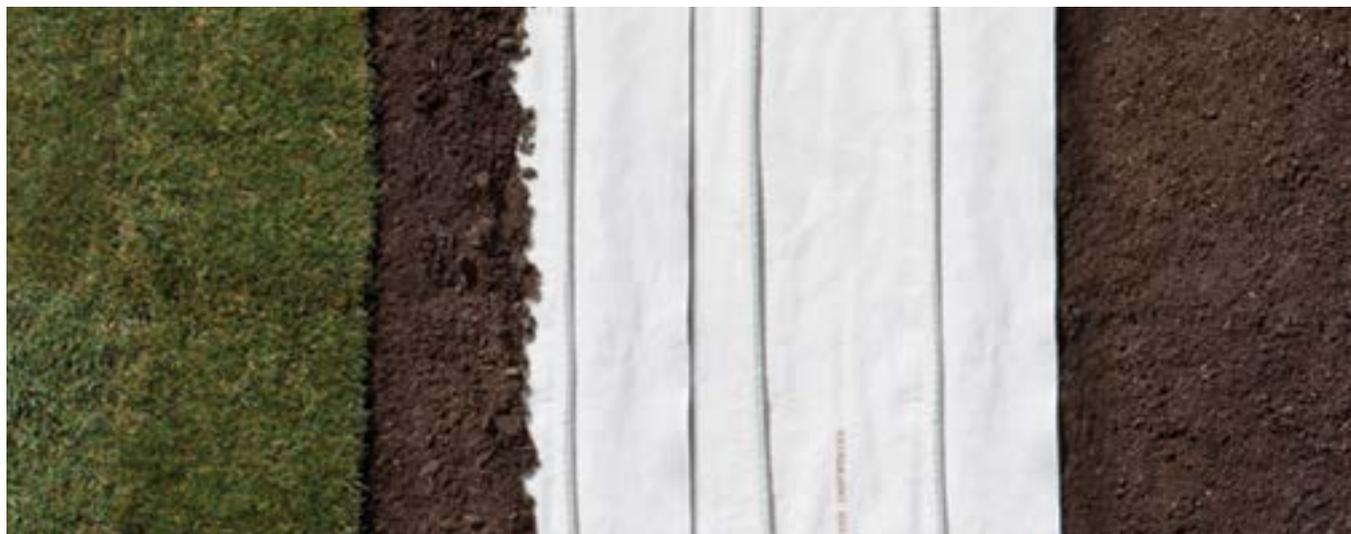
O Eco-Mat é um produto de irrigação de subsuperfície de tecnologia avançada. Ele é formado por um tubo gotejador profissional de paisagismo de alta qualidade envolto em lã de propileno e conectado a um tapete capilar. Esse tapete de lã especial movimenta a água por qualquer tipo de solo, até mesmo inconsistentes, e promove o crescimento duradouro da raiz e de plantas mais saudáveis.
