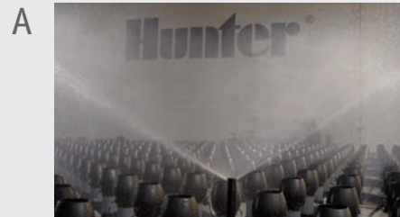
Los aspersores son sometidos a pruebas en el Precipitation Analysis Lab.
