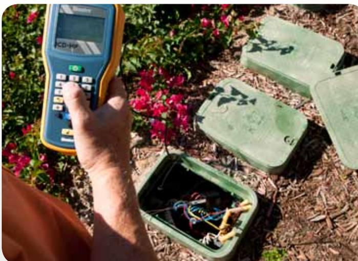
Gracias a su innovador sistema de inducción inalámbrica, el ICD-HP permite acceder a todo un abanico de funciones de programación, de diagnóstico y de funcionamiento sin necesidad de retirar los conectores estancos. El interfaz de inducción del programador se comunica sin cables con los decodificadores Hunter a través de la carcasa del decodificador.
