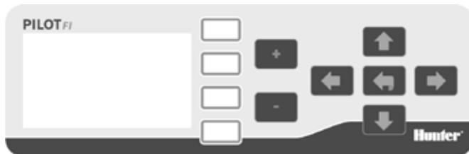
PILOT-FI 控制面板用于设置和故障排除。
