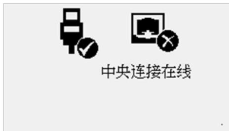
2. 将会显示现场接口与中央计算机之间的连接。如果同时连接了 USB 和以太网电缆，系统将使用以太网连接。
