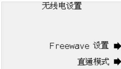
2. 选择“直通模式”将无线电置于直通模式，以进行检测和故障排除。
