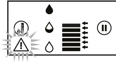
يقوم زر التوقف بتجاهل جهاز التحكم برطوبة التربة Soil-Clik. وهذا يسمح للوحة التحكم بالري بشكل طبيعي، حتى إذا تم الوصول إلى مستوى الرطوبة المطلوب في التربة.
