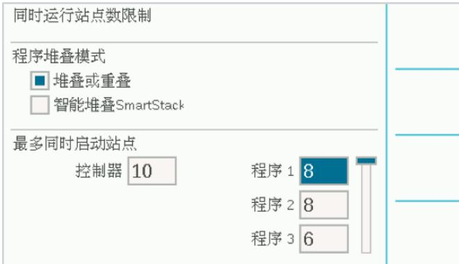
**最多同时启动站点**设置控制器一次可以运行的站点数的硬限制，此限制高于“流量管理”或其它设置的权限。ACC2传统连线的控制器可以一次运行约14个Hunter电磁阀，包括泵/主阀输出。其它因素可能会影响最大可运行站点的数量。
