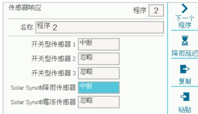
电源板上有三个标准开型 (Clik) 传感器输入。如果配置了亨特 Solar Sync 传感器，还可以设置 Solar Sync 降雨和霜冻传感器。
