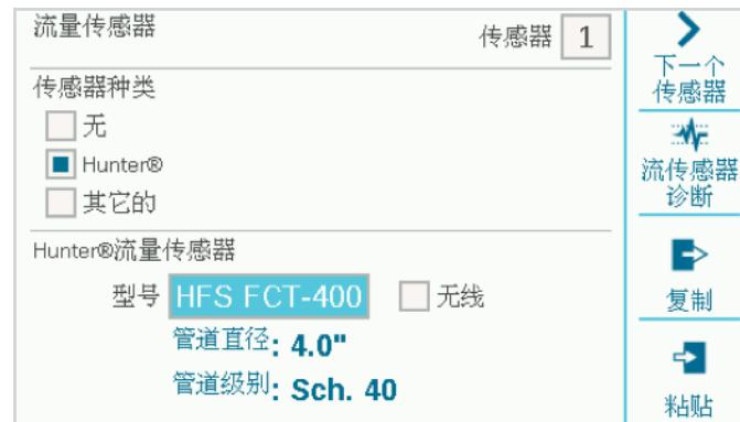
选择要设置的传感器输入编号（1-6）。控制器内置3个流量传感器输入，但可通过A2C-F3流量扩展模块另添加3个。
