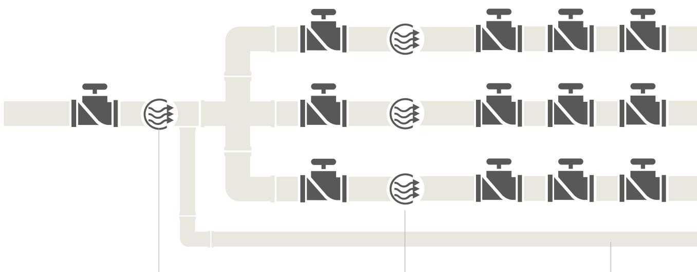
*Un sensore MainSafe, con una Master Valve normalmente aperta, monitorano l'intera fonte di approvvigionamento idrico, incluso il consumo d'acqua mensile.*
