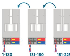
Ciascun modulo di uscita A2C-D75 comanda 75 stazioni e supporta fino a tre monocavi nell'impianto. È possibile collegare facilmente più di 75 stazioni ad un unico monocavo, assegnando le stazioni da un modulo all'altro.
