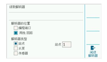
该菜单的解码器类型现在可以选择"站点"、"水泵"或"传感器"。 选择要重新编程的解码器的类型,然后输入地址。按"阅读解码器" 获取您选择的项目的当前设置,然后输入更改。按"程序解码器"将 更改从两线回路发送到选定的解码器。
