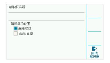
然后按标有"阅读解码器"的软键。这将返回端口中解码器的配置, 并带有用于输入站点号的屏幕。如果屏幕显示"找不到解码器!", 解码器导线可能已断开,或者可能插入了错误的导线。
