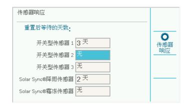
**降雨延迟**: 在"传感器响应"菜单中,按下"降雨延迟"软键。 这个可选的设置会在传感器激活结束后的几天内使浇水停止。 选择每个开关型传感器停止浇水的天数。
