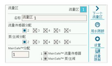
流量传感器分配: 选中流量传感器 (连接到流量区的传感器)。
