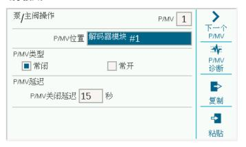
如果该位置设置为其中一个解码器模块,则控制器知道泵/主阀输 出被分配给两线回路上的解码器。如果有多个解码器输出模块, 则指定它是哪个解码器模块(1,2或3)是很重要。
