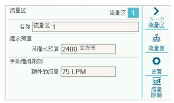
**灌水预算**: 输入日历"月"中此"流量区"中允许的总用水流量。 如果总流量超过每月预算,则会在屏幕上显示一条警报消息。 发生报警时,控制器不会自动停止浇水。
