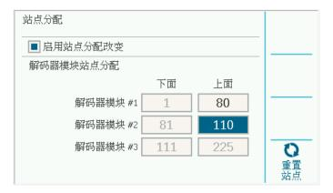
每个输出模块在安装时默认提供75个站点。如果在单条两线回路上或单个模块的回路上需要超过75个站点,则可以将站点号从 其他模块重新分配到第一个模块,依此类推。
