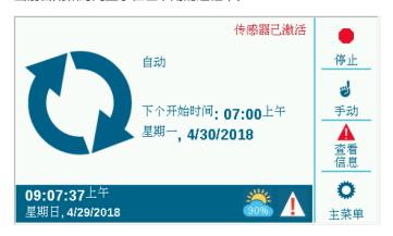
如果Solar Sync已安装并启用("**设备**"菜单),Solar Sync符号将在右下角边框并显示当前调整百分比。
