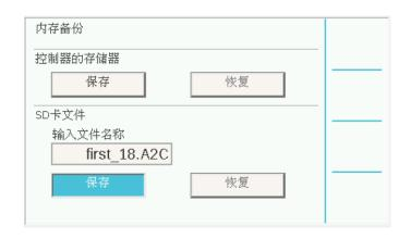
控制器的存储器: 控制器内存中只能保存一个控制器设置, 除非您更改了设置并在将来创建新的内存Easy Retrieve备份, 否则它将一直保留。您可以随时选择"恢复",并将整个控制器更 改为上次Easy Retrieve备份。
