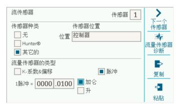
**脉冲**: 输入等于单个脉冲的流量。输入连接到流量计端口的每个流量传感器的信息。如果所有流量计都是相同的类型和尺寸,则可以使用"复制"和"粘贴"软键。
