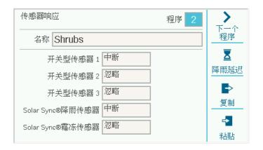
电源板上有三个标准开关型 (Clik) 传感器输入。如果配置了亨特 Solar Sync传感器,还可以设置Solar Sync 降雨和霜冻传感器。
