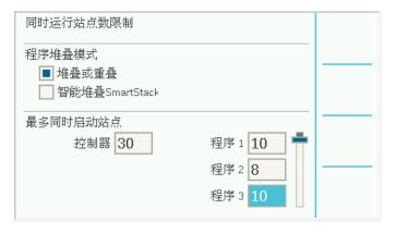
不管"流量管理"或其他设置如何、"最多同时启动站点"都可以 对控制器一次可以运行的站点数量设置硬性限制。ACC2解码器 控制器可以在单个输出模块上同时运行约20个Hunter电磁阀, 包括泵/主阀输出。如果解码器控制器安装了多个解码器输出模块, 则每个输出模块的可启动不超过20个站点,而整部解码器控制器 可以一次运行多达30个站点。
