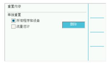
**所有程序和设备**: 清除所有程序和设备设置,但保持"流量总计" 不变。
