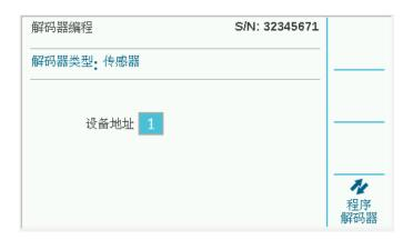
选择传感器解码器地址,然后按下"程序解码器"软键编程解码器。 在解码器上写下标记并安装在该传感器设计位置。
