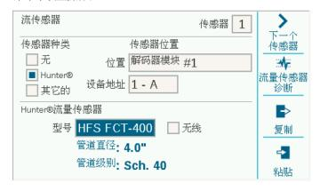
选择要设置的传感器输入编号 (1-6)。控制器内置3个流量传感器输入,但可通过A2C-F3流量扩展模块另添加3个。
