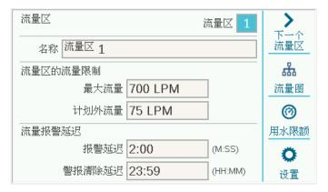
**最大流量**: 出于任何原因,设置流量区中允许的最高流量。 这应该比正常灌溉所允许的最大流量大得多(以便在进行站点级 诊断之前不会发出警报)。当流量传感器检测到高于此的流量时, 灌溉将被关闭。
