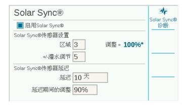
Solar Sync传感器延迟 允许在自动Solar Sync调整生效之前等待若干天(例如,新种植的绿化加强补水)。输入要等待的天数(1-250),并指定延迟期间使用的延迟调整百分比。,在延迟结束时Solar Sync将开始自动调整当前的气候条件。
