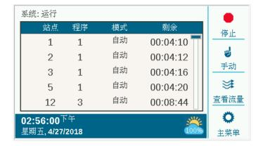
软键通常显示"停止"、"手动","查看流量"(如果流量传感器已安装并启用时显示当前流量)和"主菜单"。"停止"和"手动" 在"基本编程"部分有描述。"查看流量"在"流量操作" 部分有详细描述。
