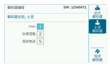
输入解码器的P/MV(泵/主阀)编号。此值必须与"设备"菜单中的P/MV分配相匹配对应。
