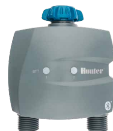
BTT-201 进口直径：¾" 和 1" 出口直径：¾" 高：15.7 cm 宽：13.5 cm 厚：7.6 cm
