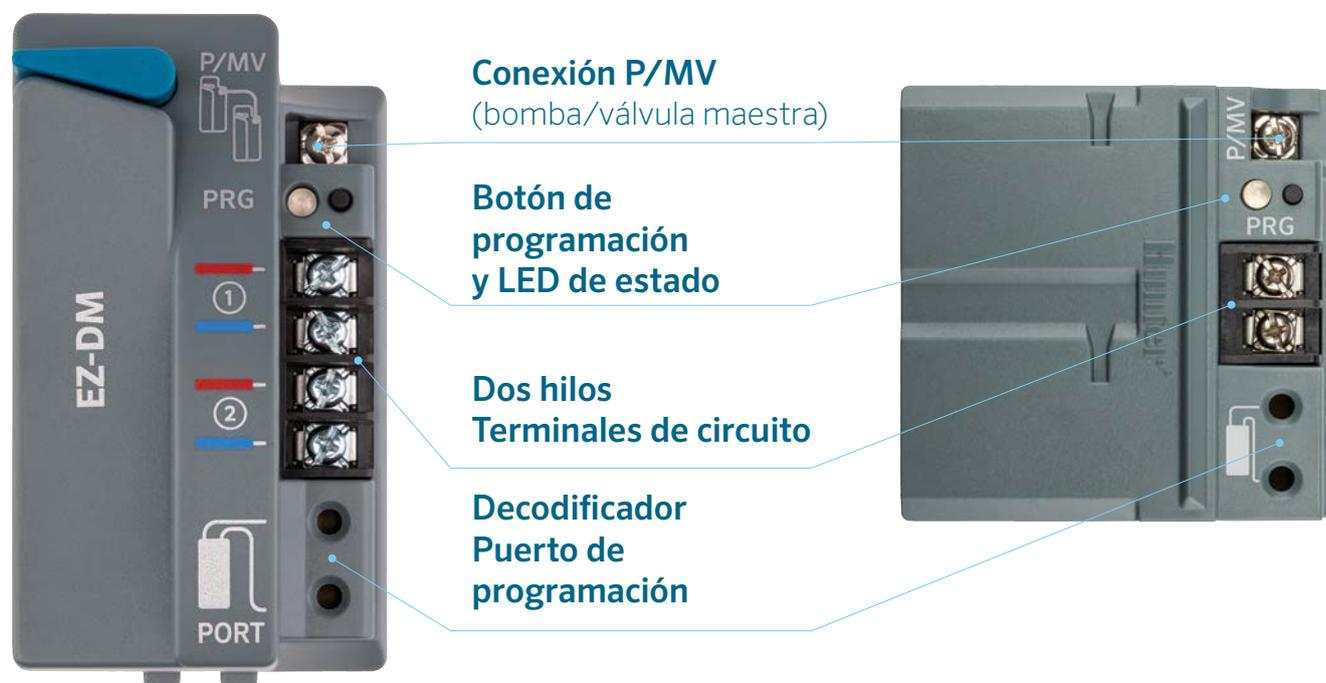
Se conecta a cualquiera de los módulos de salida para activar los solenoides de riego, más una válvula maestra, con solo un par de cables. A continuación, coloque los decodificadores EZ-1 en cada válvula.
