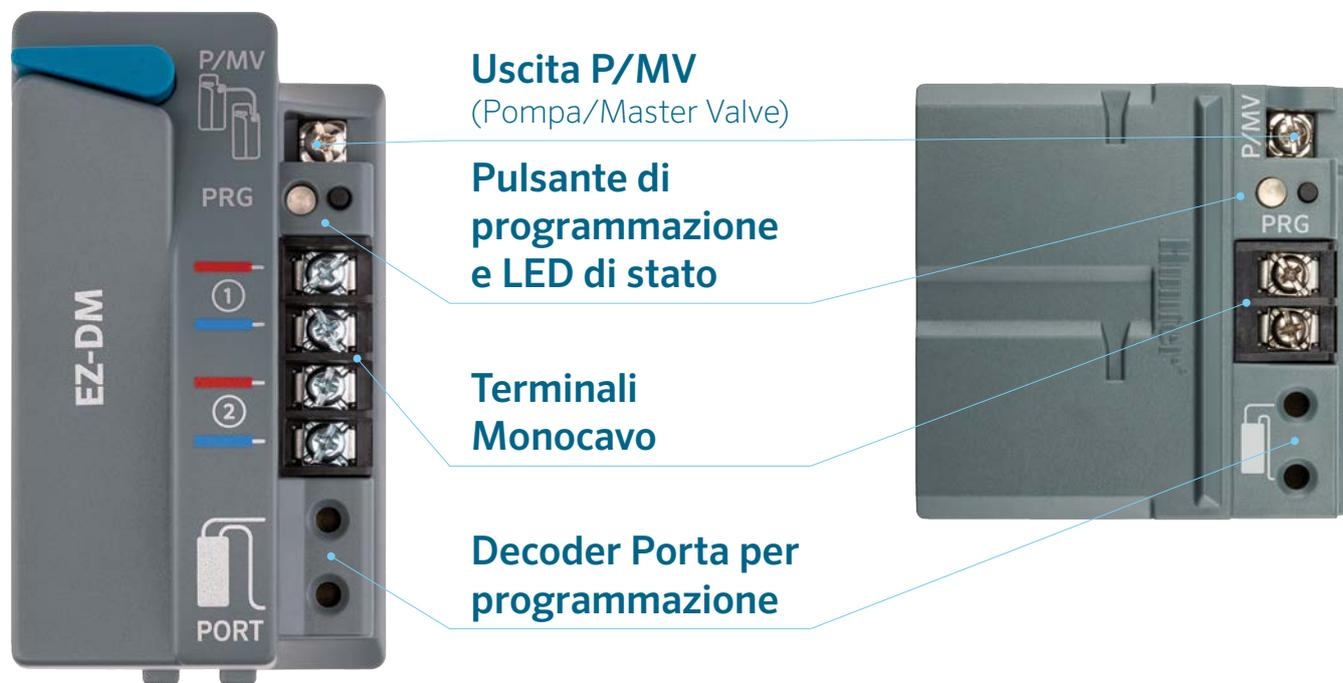
Inserite un modulo di uscita per monocavo per azionare i solenoidi delle elettrovalvole ed una Master Valve con un'unica coppia di fili, quindi collegate i decoder EZ-1 a ogni singola valvola.
