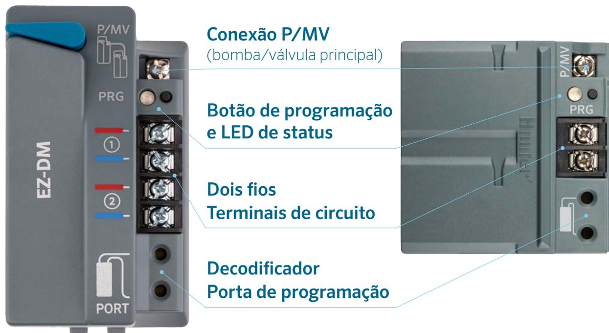
Conecte o módulo de saída de dois cabos para ativar as solenoides de irrigação, além de uma válvula mestre, em um único par de cabos. Depois disso, basta colocar decodificadores EZ-1 em cada válvula!
