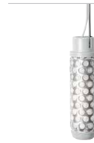
SC-PROBE 土壤湿度传感器探头 直径：2.5 cm 高度：8.3 cm 控制器到探头的距离：最远 30 m 1mm 2 直埋式线缆
